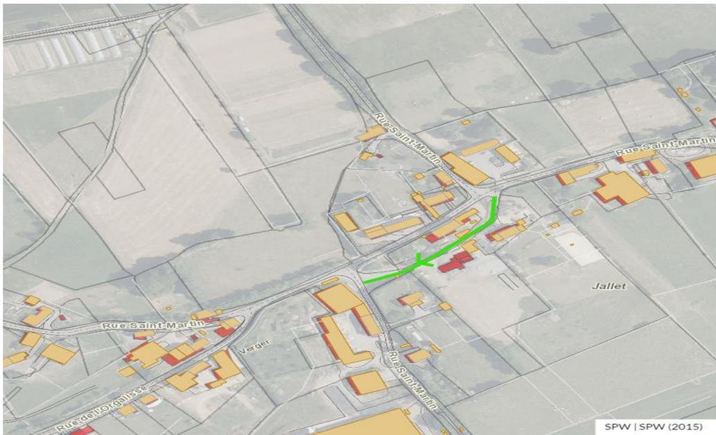
La mesure sera matérialisée par le placement de signaux C1 (complété d'un panneau M2 et d'un panneau M4) et F19 (complété d'un panneau M4).
